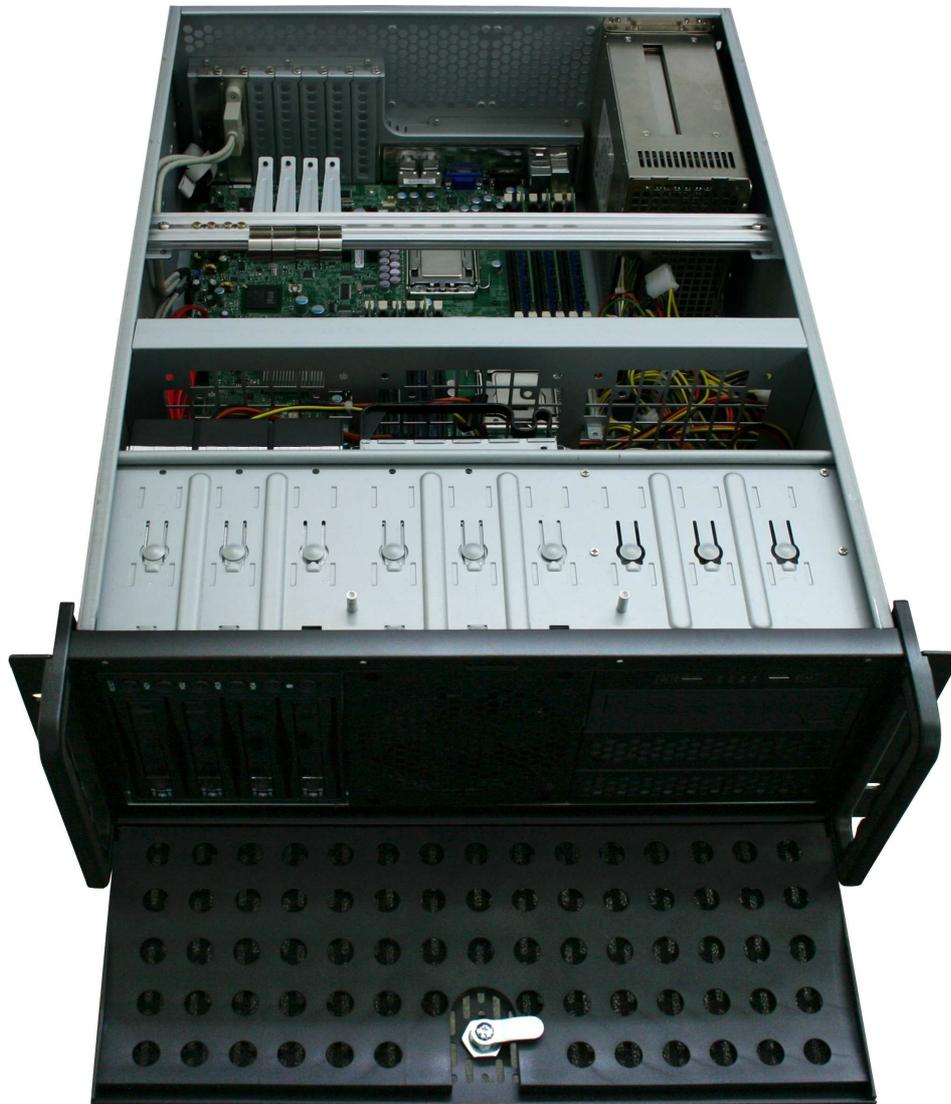
Das Inter- Tech **Rackmount Extended Barebone** ist die ideale Basis für ein professionelles Server System. Ausgestattet mit Staubfilter, Wechselrahmen, redundantem FSP®-Netzteil, sowie einer vorgefertigten Verkabelung, brauchen Sie nur noch CPU, Hauptspeicher und Festplatten einbauen. Es bietet Platz für bis zu 4 Festplatten (3,5" SATA) im Wechselrahmen und bis zu 4 Festplatten intern (3,5" SATA). Ein DVD Laufwerk ist ebenfalls schon eingebaut.
