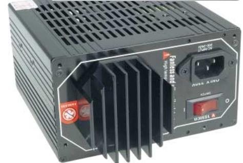
Yesico FL-350ATX: brummt unter Last etwas, knickt bei dauerhafter Hochlast ein, mangelhafte Störimmunität
