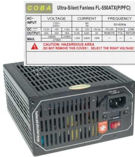
**Coba FL-550ATX:** lüfterlos und fast geräuschfrei, brummt etwas bei Hochlast
