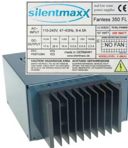
Silentmaxx Fanless 350 FL: geräuschlos mit massivem Kühlkörper, aber nicht für dauerhaft hohe Last geeignet
