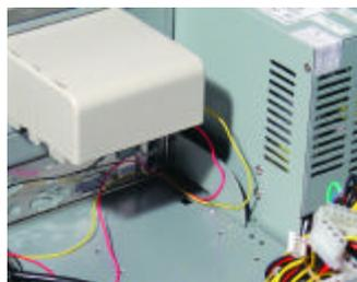
STÖREND Ein solcher fehlplatzierte Gehäuselüfter stört bei der Montage eines ordentlichen CPU-Lüfters.
