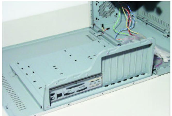
**PRAKTISCH** Ein solcher herausklappbarer Mainboard-Schlitten erleichtert den Umbau der Hardware. Leider verfügt nur das 2011-Gehäuse über dieses Feature.
