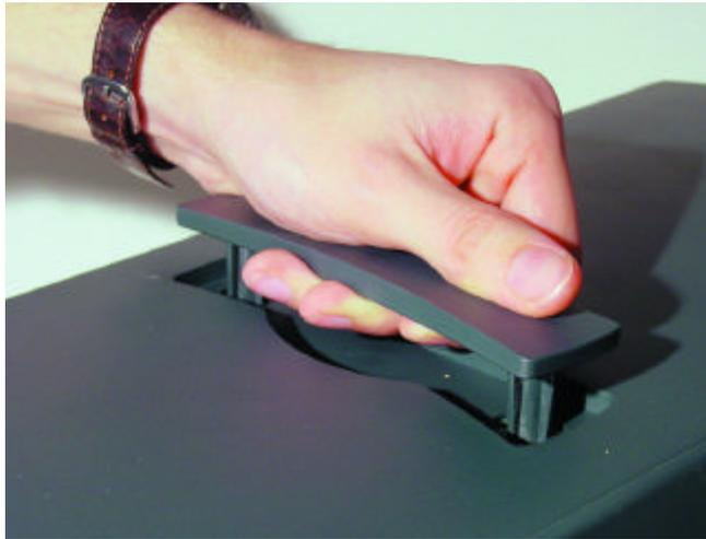
GRIFFIG Das Vantage-Gehäuse von CSD Computer besitzt einen kräftigen Tragegriff. Nach Herstellerangaben hält er bis zu 60 Kilogramm.
