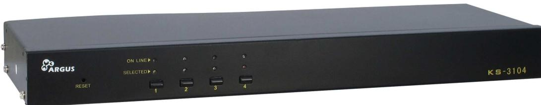
Der **KVM KS-3104** ist ein professioneller 4-Port KVM-Switch. Er findet vornehmlich in Serverschränken Anwendung wo mehrere Server installiert sind, die durch die integrierte Umschaltungsmöglichkeit zentral über den **KVM KS-3104** mit einer Tastatur, Maus und einem Monitor bedient werden können.
