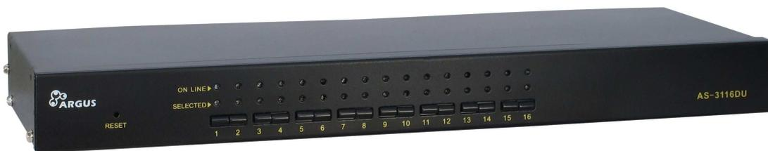
Der **KVM AS-3116DU** ist ein professioneller 16-Port KVM-Switch. Er findet vornehmlich in Serverschränken Anwendung wo mehrere Server installiert sind, die durch die integrierte Umschaltungsmöglichkeit zentral über den **KVM AS-3116DU** mit einer Tastatur, Maus und einem Monitor bedient werden können.
