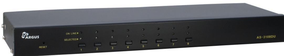
Der **KVM AS-3108DU** ist ein professioneller 8-Port KVM-Switch. Er findet vornehmlich in Serverschränken Anwendung wo mehrere Server installiert sind, die durch die integrierte Umschaltungsmöglichkeit zentral über den **KVM AS-3108DU** mit einer Tastatur, Maus und einem Monitor bedient werden können.
